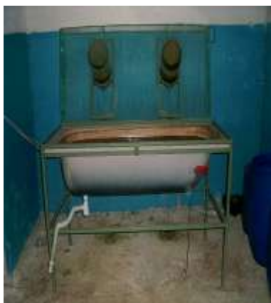
Рис. 3. Установка для синтеза микроводоросли УМВ-60
